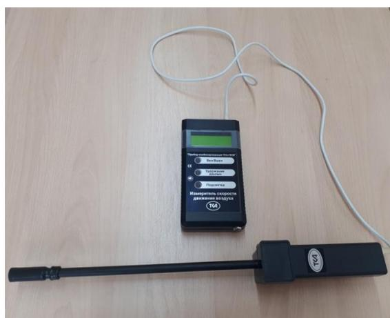
**Рисунок 9 – Термоанемометр «ТКА-ПКМ» (модель 50)**
