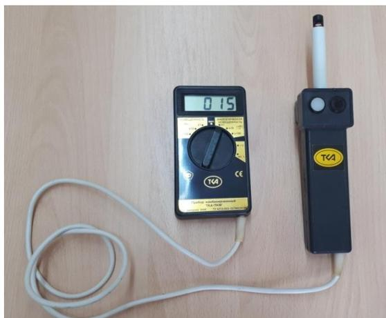
**Рисунок 8 – Комбинированный прибор «ТКА-ПКМ» (модель 42)**
