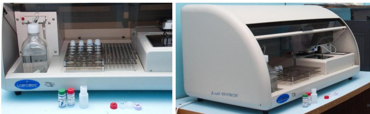
**Рисунок 13 - Анализатор «Chem Well Combo»**
